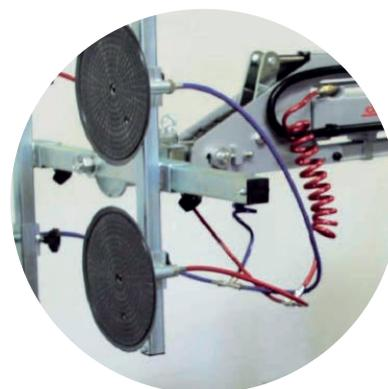
Le circuit de vide est divisé et croisé en deux lignes pour plus de sécurité. Voici les deux lignes de vide d'air avec des flexibles respectivement bleus et rouges.
