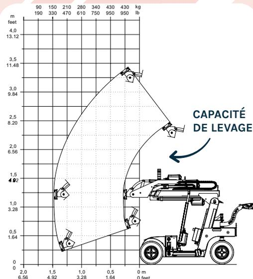
Le Smartlift SLI 409 est un multi élévateur puissant, parfaitement adapté à un large éventail d'industries.
